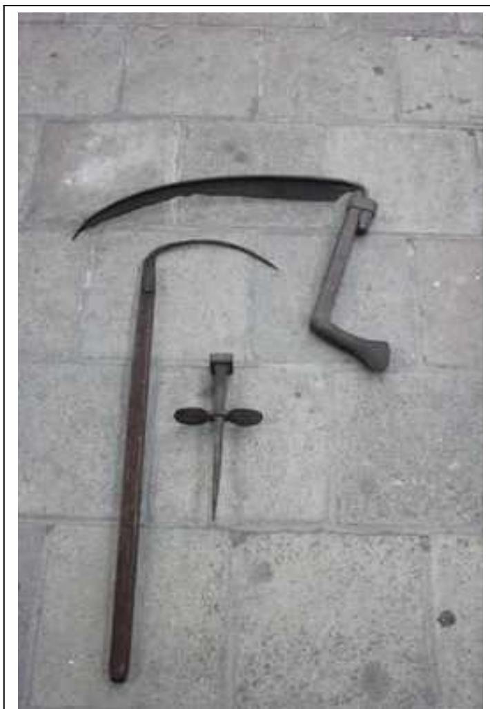
Un piquet (ou sape), le havet (ou crochet) et l'enclumette
