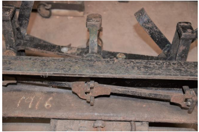
Le fléau inférieur est « caché » dans le socle en fonte
